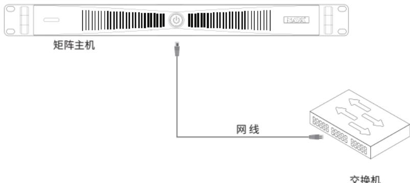
性能说明:为保证设备承载性能充分发挥推荐接入的以太交换机端口最低以10/100Mbps
